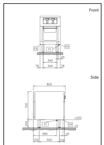
Electrical inlet (power) EQ Equipotential screw
